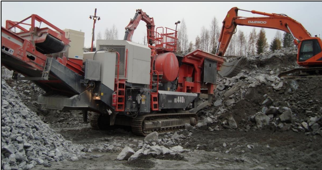
Kuva 1 Esimerkki Lokotrack-tyyppisestä esimurskaimesta (Sandvik UJ440i vm. 2008) kalliokiven murskauksessa. [9]
